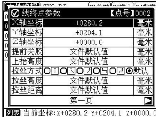
“手动对点”模式：进入如图 2-10 所示的点参数编辑界面之后，先按 **Pos** 按键，等待胶头移动完成后，就可以直接用方向键来控制胶头移动来手工定位到新的坐标，然后按 **Ent** 按键即可保存新的坐标值，如下图所示。
