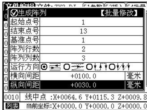
按图上参数设置：起始点号：1；结束点号：13；基准点号：1；阵列行数：2；阵列列数：3；横向间距：100；纵向间距：30。然后按 [Esc] 按键退出并按照提示确认修改。
