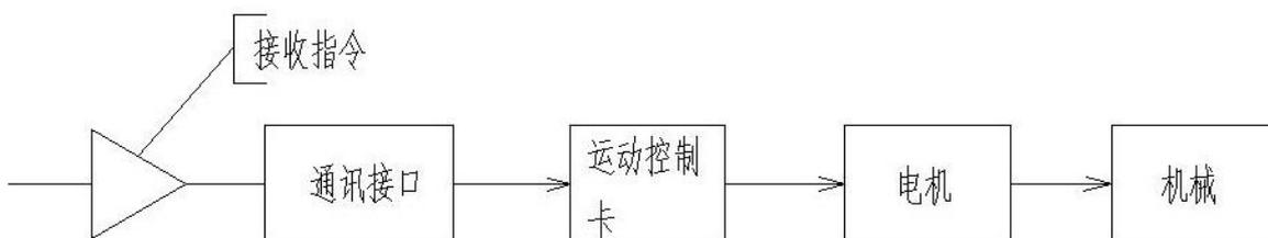
图2-1 点胶机器人结构示意图
