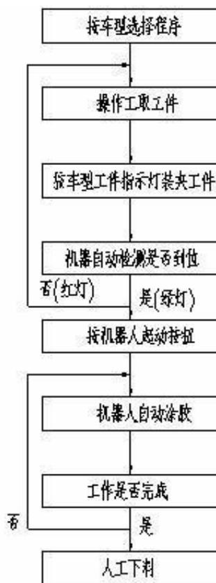
图 4-5 点胶机点胶流程
